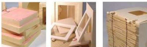
実験パーツ：断熱材、窓材、遮熱材 出典：風大地プロジェクト HP https://kazedaichi-pro.jp/kaishashoukai.html
