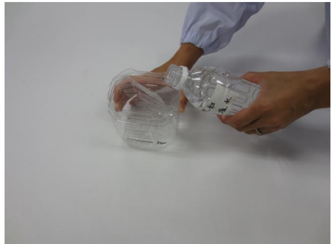
2. 飽和食塩水の注入
